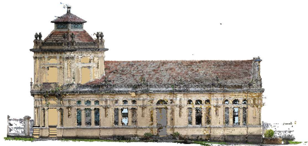
Figura 48 - Nuvem de pontos posicionada junto com a fachada sul planificada em formato .e57
