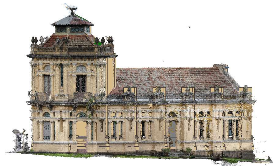
Figura 50 – Nuvem de pontos posicionada com foco nas Laterais sul e oeste em formato .e57
