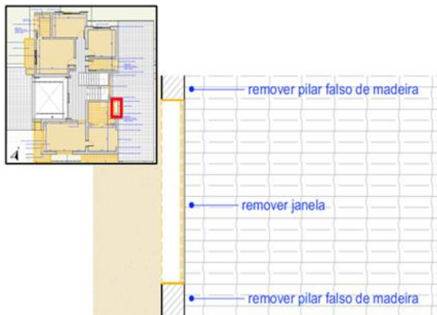
Figura 16 - Detalhe do projeto de demolição
