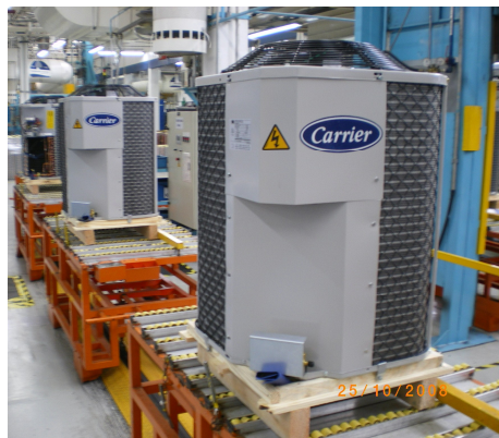
Figura 1.1 – Unidade condensadora modelo 38CCC de 16690W (57 kBtu/h)
