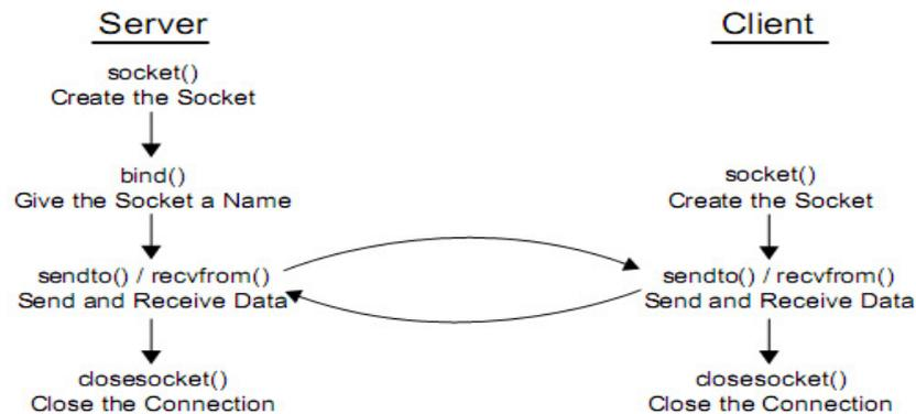
**Figura 13 - Comparativo de fluxogramas de comunicação via sockets – TCP x UDP**
