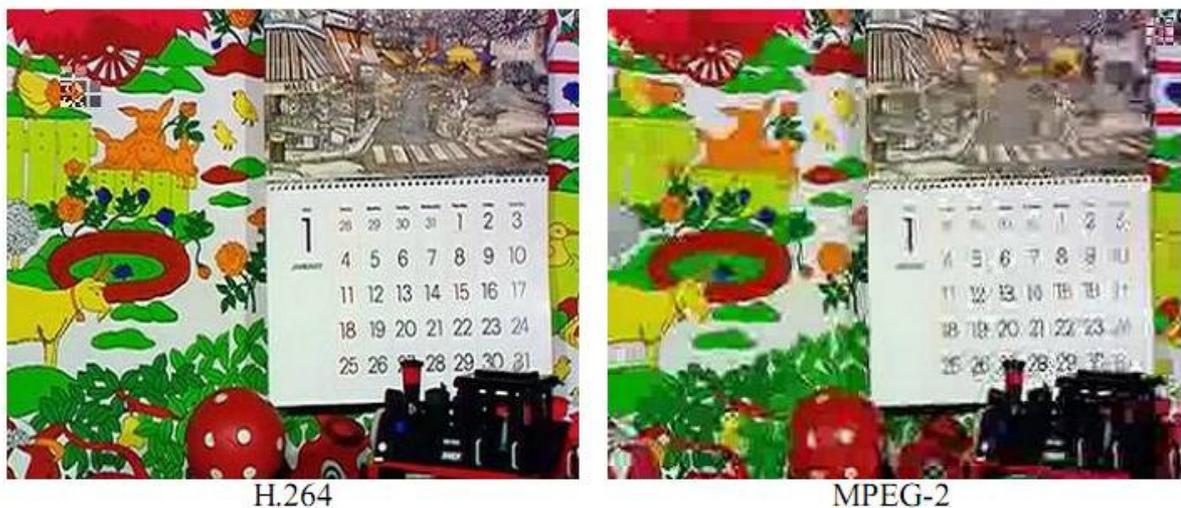
**Figura 1 - Comparação entre o padrão H.264 e MPEG-2**
