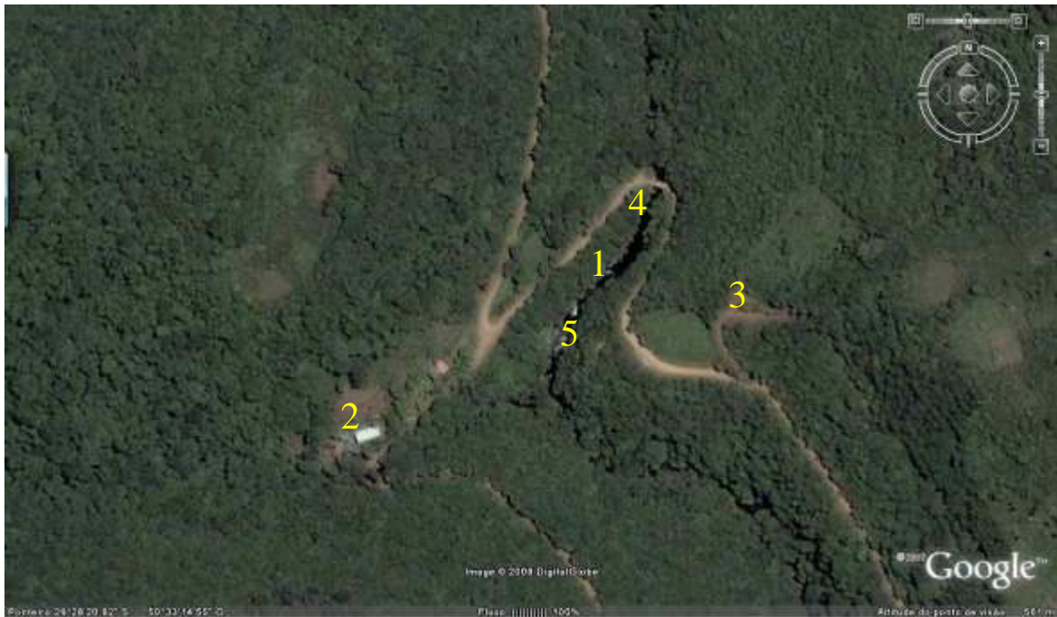
FIGURA 25 - Vista panorâmica da PicoCH da Ponte. (1) 1ª. queda do aproveitamento, (2) vizinho mais próximo da PicoCH e que recebe energia da mesma, (3) vizinho que não recebe energia da PicoCH, (4) barragem, (5) casa de máquinas. [Fonte: Google Earth, 2008]
