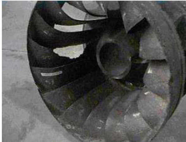
FIGURA 13 - Exemplo do efeito destrutivo da cavitação em um rotor tipo Francis.
