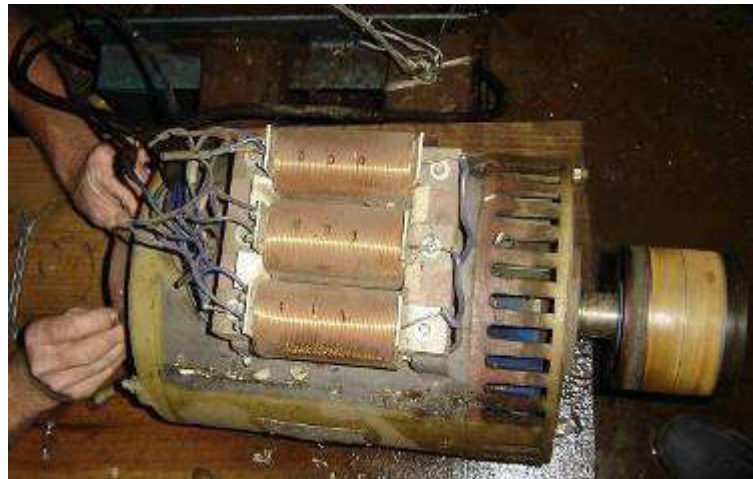
FIGURA 38 - Gerador Síncrono utilizado na MCH.
