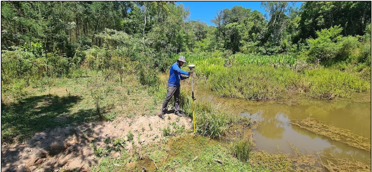
Figura 19 – Levantamento topográfico, do açude Linha Preta utilizando GPS-RTK
