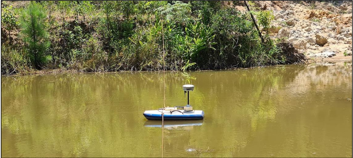
Figura 20 – Batimetria do açude Linha Preta utilizando RTK acoplado ao ADCP (M9).
