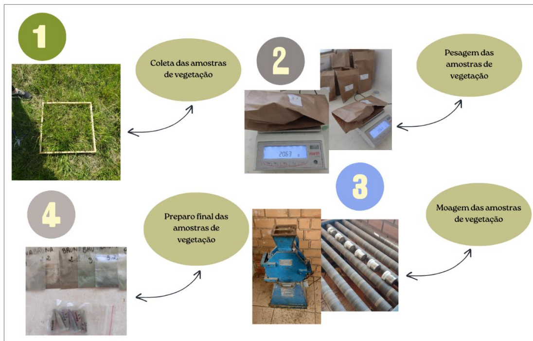
Figura 3 - Metodologia aplicada para posterior obtenção de biomassa e carbono dos pontos amostrais. (1) coleta da vegetação por meio do método do quadrado; (2) pesagem da vegetação antes e após secagem em estufa; (3) moagem das amostras em moinho e posterior em cilindro, (4) preparo das amostras para envio laboratorial.
