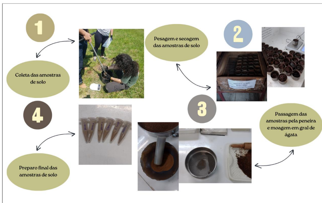
Figura 5 – Metodologia aplicada para obtenção do carbono orgânico total do solo nos três pontos amostrais. (1) coleta das amostras de solo com uso de trado holandês; (2) preparo das amostras para secagem em estufa; (3) passagem das amostras secas em peneira e moídas em gral de ágata; (4) preparo das amostras para envio ao laboratório.
