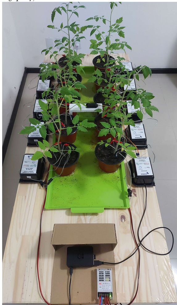
Figura 25 – Primeiro arranjo experimental, formado por 10 nós sensores, um sensor AM2301, um raspberry pi 4 , uma fonte de tensão e 10 tomateiros.
