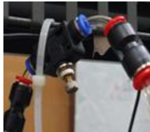
Figura 5.6: Instalação de válvulas manuais
