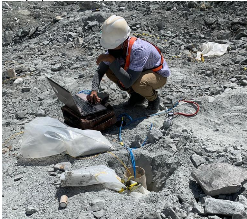
Figura 21 - Aquisição dos dados de pressão absoluta no desmonte com o sensor DCD
