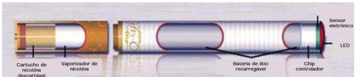
Figura 2 – Funcionamento do Cigarro Eletrônico.
