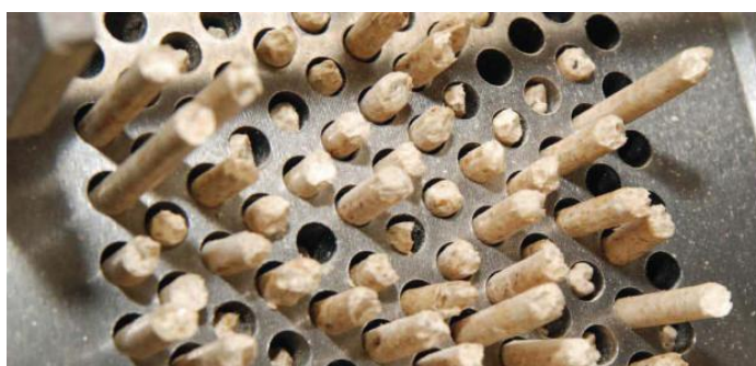
Imagem 5 - Placa de passagem do pelete Fonte: JLima Máquinas, 2022
