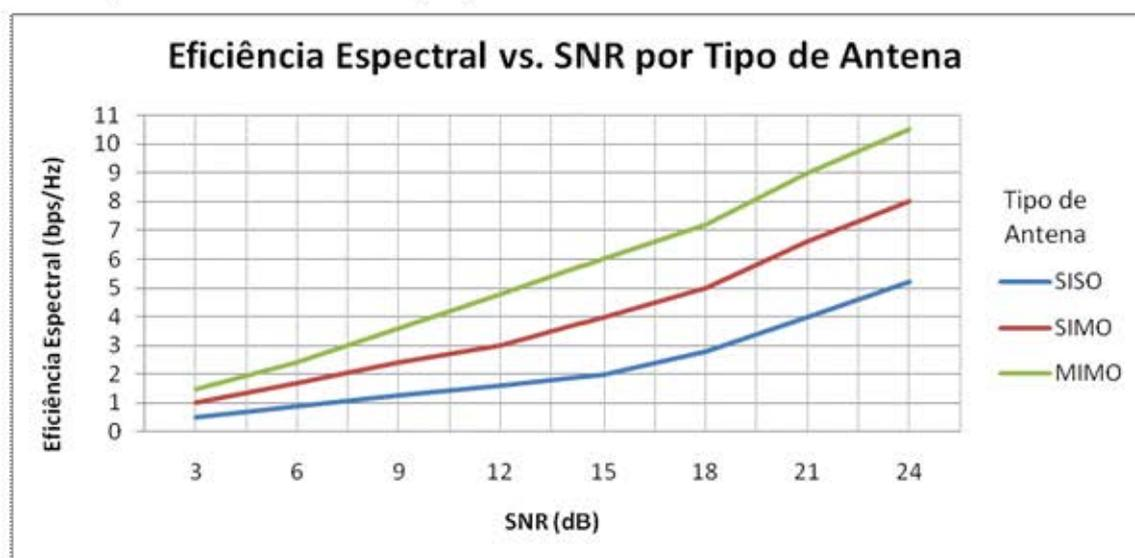
Figura 4.3: Eficiência espectral versus relação sinal/ruído por tipo de antena
