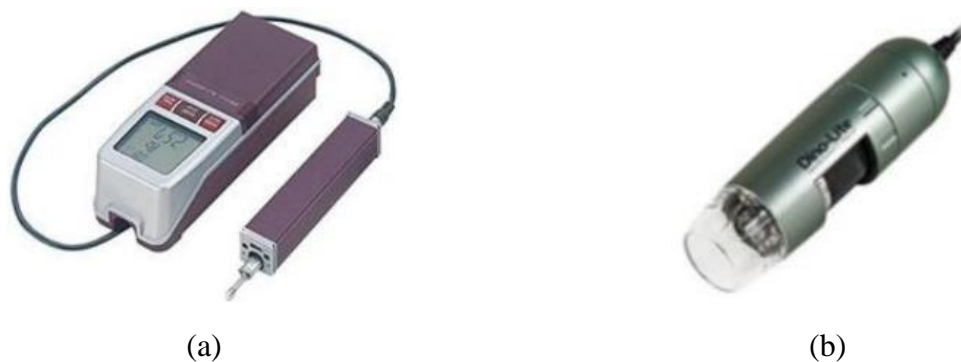
Figura 4 – (a) Rugosímetro Mitutoyo SJ-201P; (b) Microscópio Dino Lite AM413-ZT.
