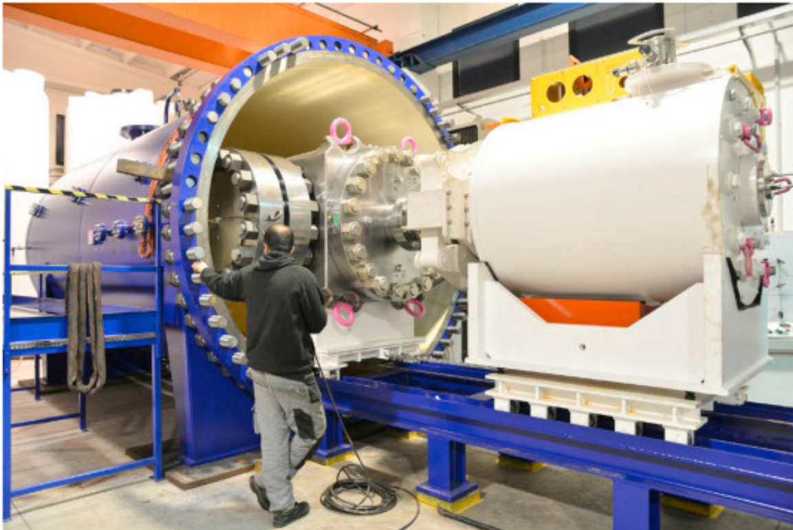
Figura 20: Teste hiperbárico aplicado em ESDVs.
