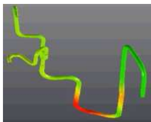
Figura 5: Imagem de animação obtida a partir da análise modal experimental em tubulação.
