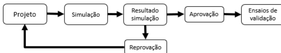
Figura 9: Esquema idealizado de etapas para desenvolvimento de novo layout de tubulação a partir da utilização de simulação numérica.
