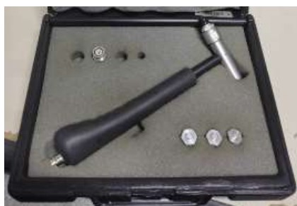
Figura 1: Martelo de impacto utilizado nos ensaios de análise modal experimental.
