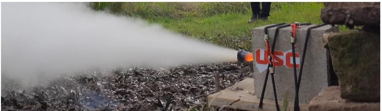
Figura 15: Segundo teste estático após aquecimento da tubeira.
