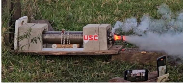
Figura 13: Motor em pleno funcionamento. Ocorre vazamento no motor e a garganta atinge temperaturas elevadas.
