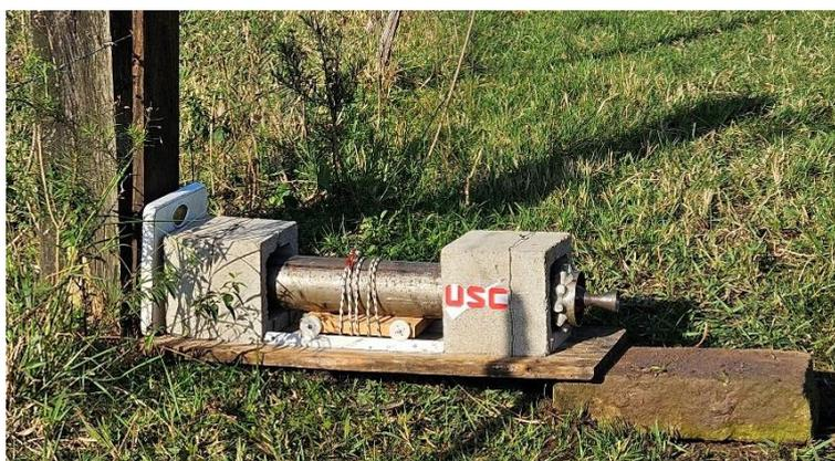
Figura 12: Primeira versão da bancada de testes. Ela ainda não possuía apoio fixo nem teto, e seu nivelamento foi feito de maneira inapropriada.
