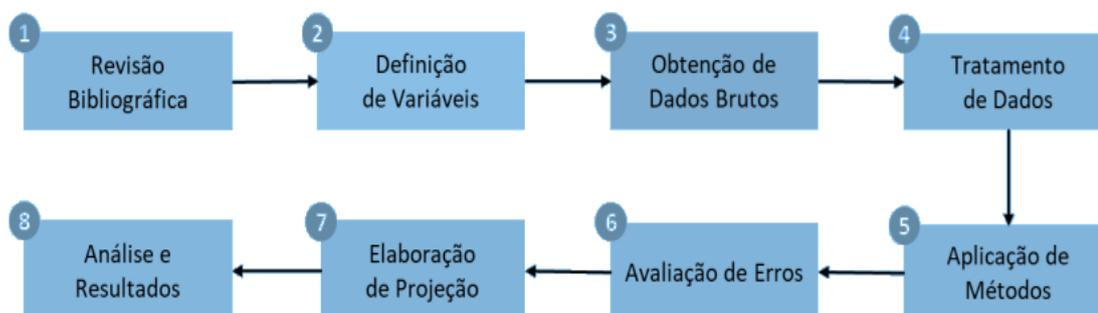
Figura 1 – Fluxograma de método proposto para projeção de demanda de consumo de gás natural em uma indústria automotiva.
