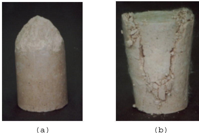
FIGURA 5.9 - Amostras apresentando formação diferenciada dos planos de ruptura (a) argila (PC7/TC20); (b) argila (PC7/CF12/TC20)
