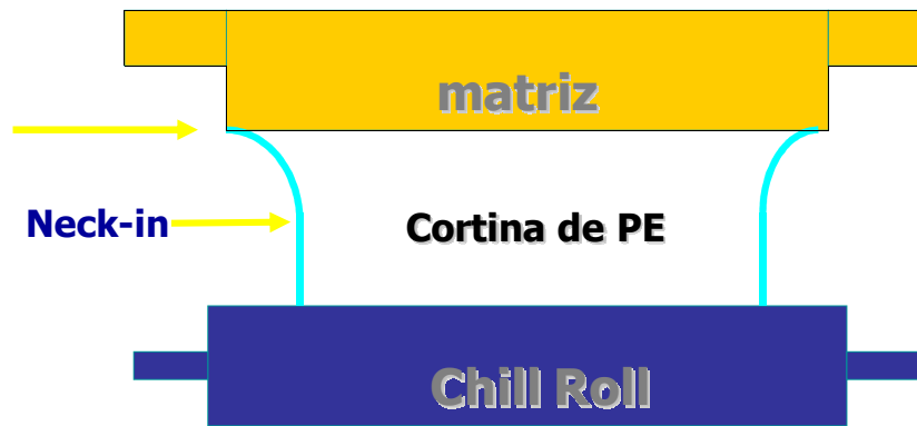
Figura 3: Neck-in - diminuição da largura do filme na saída da extrusora
