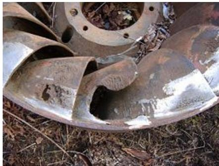
Figura 4 – Dano causado pelo efeito da cavitação.
