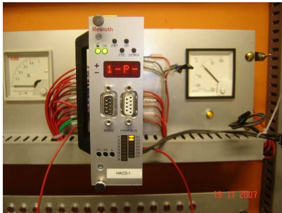
Figura 9 Cartão de controle de posicionamento da calha de frenagem
