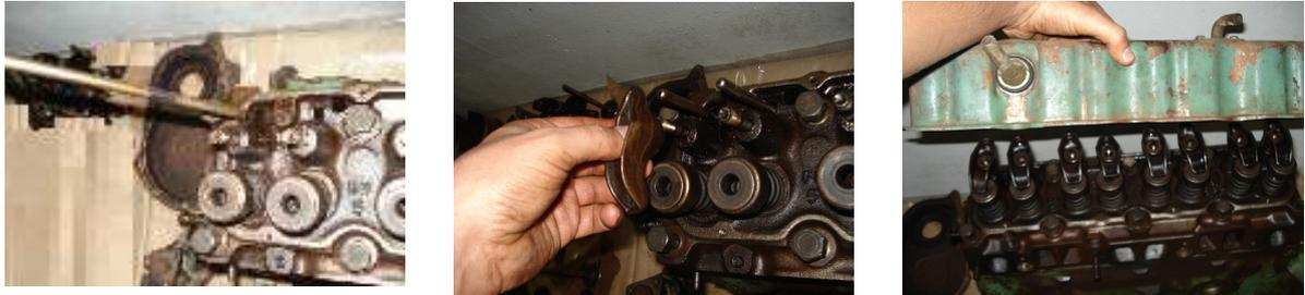
Figura A11 – Montagem das varetas, Balancins e Tampa das válvulas.
