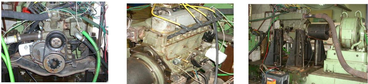
Figura A12 – Bomba D'água, Tampa lateral, distribuidor e instalação no dinamômetro.
