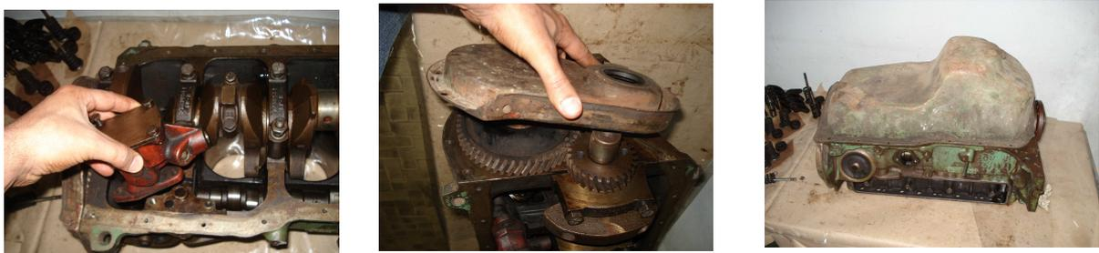
Figura A10 – Montagem da Bomba de óleo, Tampa frontal e Carter do óleo.
