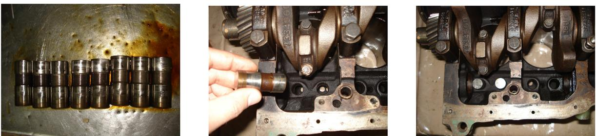
Figura A7 – Montagem dos reguladores hidráulicos.
