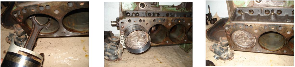
Figura A5 – Montagem dos êmbolos com a cinta
