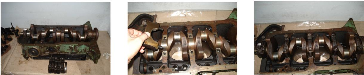
Figura A2 – Montagem da árvore de manivelas ao bloco.
