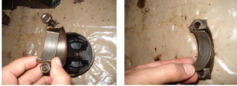
Figura A4 – Montagem as bronzinas de biela.
