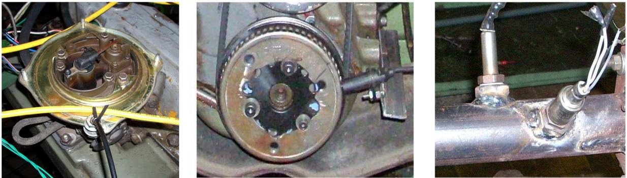
Figura 3.2 – Atomizador, Roda Fônica e Sondas Lambda.
