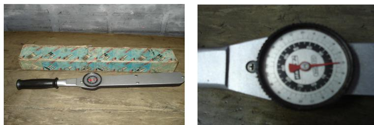
Figura A3 – Torquímetro utilizado na montagem do motor.
