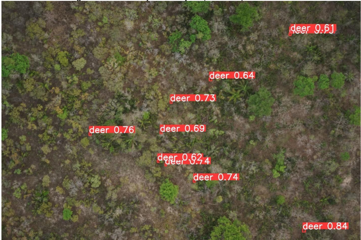
Figura 8 – Exemplo de detecções incorretas em imagem aérea de fundo complexo com atributos vegetais confundidos por cervos-do-pantanal obtidas através de algoritmo de detecção de objeto (YOLOv8) treinado
