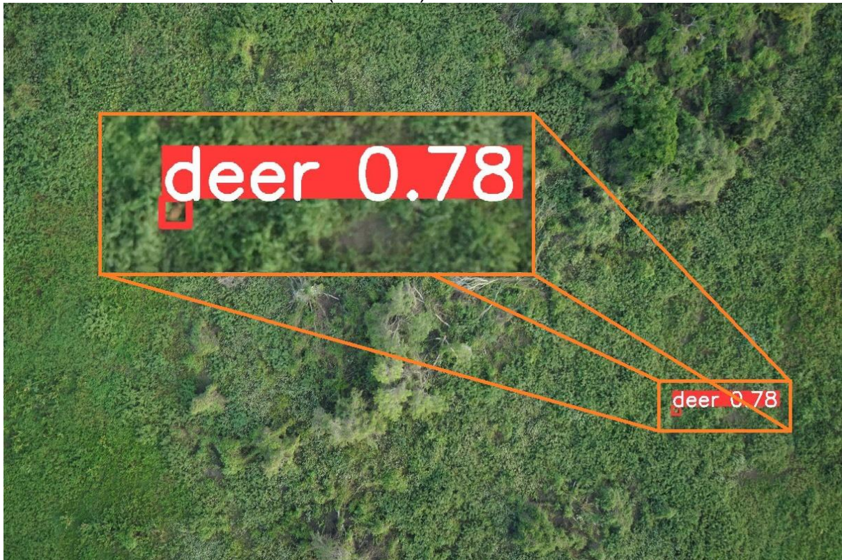
Figura 7 – Exemplo com recorte aproximado de detecção correta do cervo-do-pantanal em imagem aérea obtida através de algoritmo de detecção de objeto (YOLOv8) treinado.
