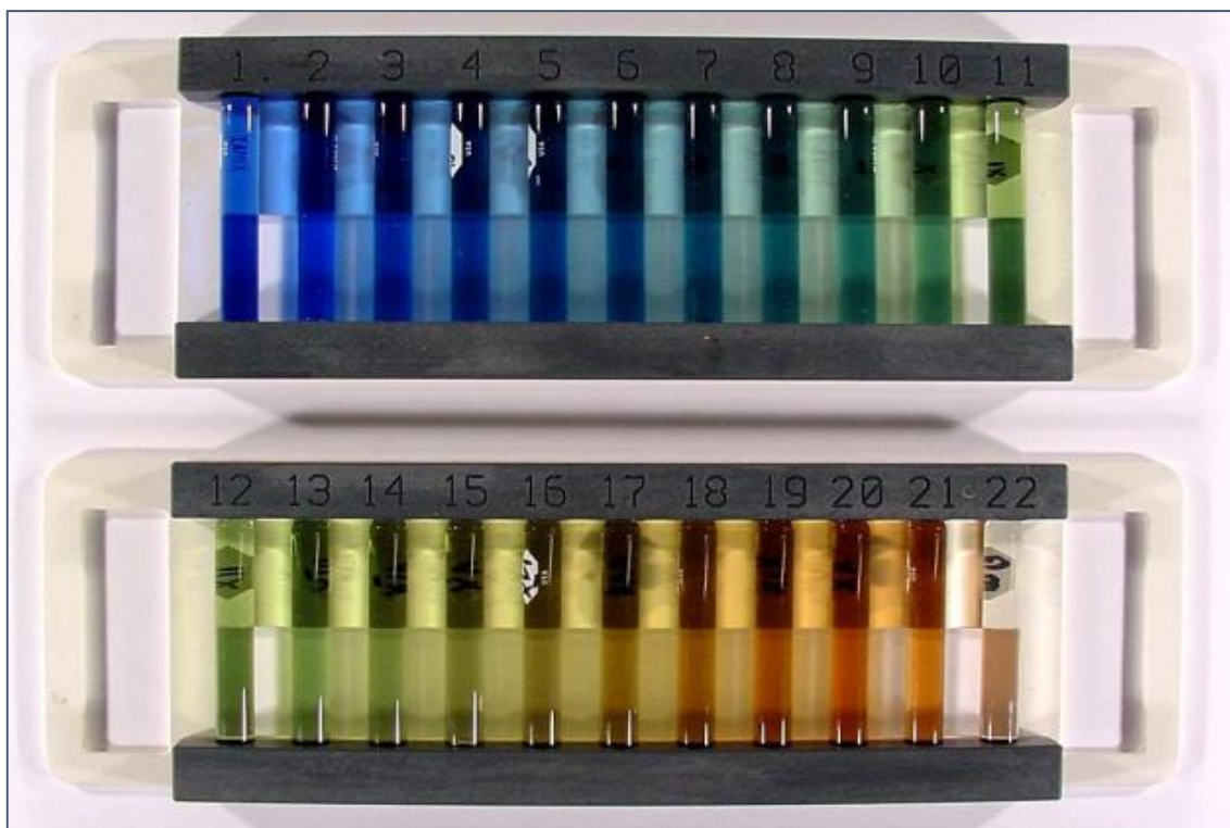
Figura 8 - Escala FU adotada atualmente com 21 cores e 1 tubo de água destilada. Fonte: Wernand, Woerd (2010).
