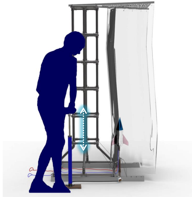
Figura 62 – Aplicação de pressão para lançamento
