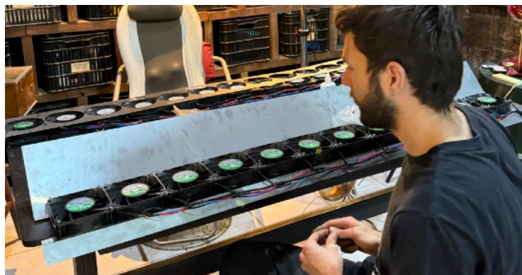
Figura 61: Ventiladores acoplados à estrutura.
