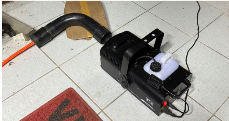
Figura 29: Máquina de fumaça acoplada ao dispensador de fluidos.
