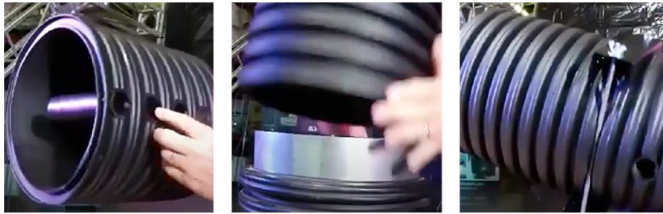
Figura 15: Montagem do dissipador da Utratec Fog Curtain
