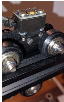
(c) Vista traseira da fixação do sensor instalado na impressora.
