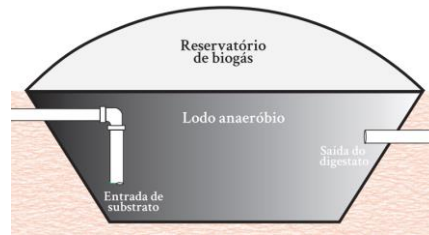
Figura 2.2 - Funcionamento de um biodigestor BLC ou canadense.
