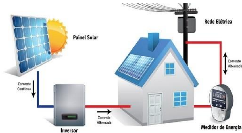
Figura 3 – Modelo de sistema fotovoltaico conectado à rede.
