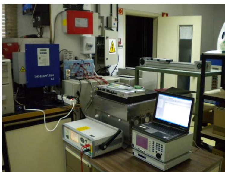
Figura 4.7 – Sistema de medida de inversores do LESF/CIEMAT.
