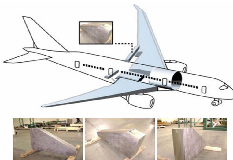
Figura 21: Peças forjadas em Titânio e desenho esquemático da sua localização no aparelho Boeing 787 (Web Site Rickard Metals, 2010)
