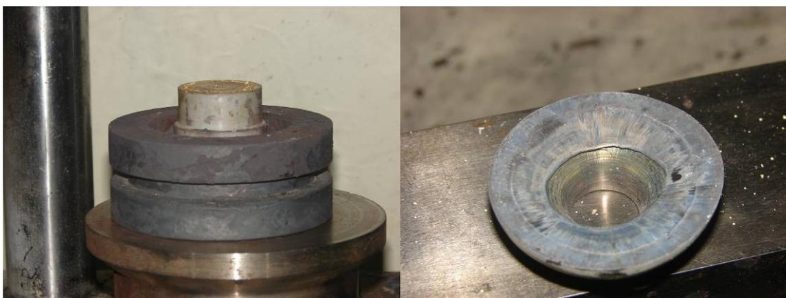
Figura 55: (Esq.) Matriz inferior sobre a base e (Dir.) Tubo de titânio conformado.
