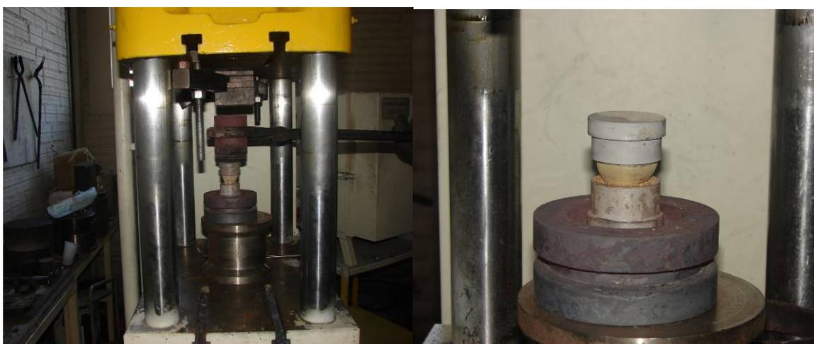
Figura 53: (Esq.) Retirada do tubo de aço e (Dir.) matrizes e o tubo conformado.
