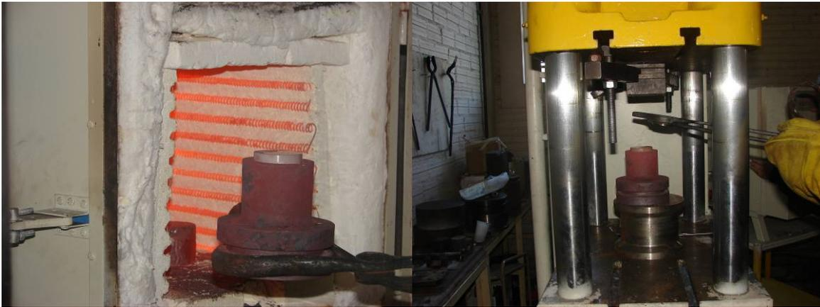
Figura 50: (Esq.) Dispositivo saindo do forno e (Dir.) dispositivo colocado na prensa.
