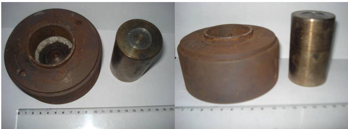
Figura 44: Dispositivo em aço ferramenta AISI H13 para conformação de alumínio.
