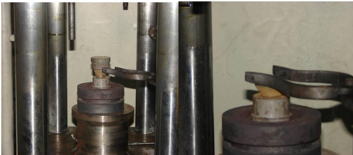
Figura 54: (Esq.) Retirada da matriz superior e (Dir.) retirada do tubo conformado.
