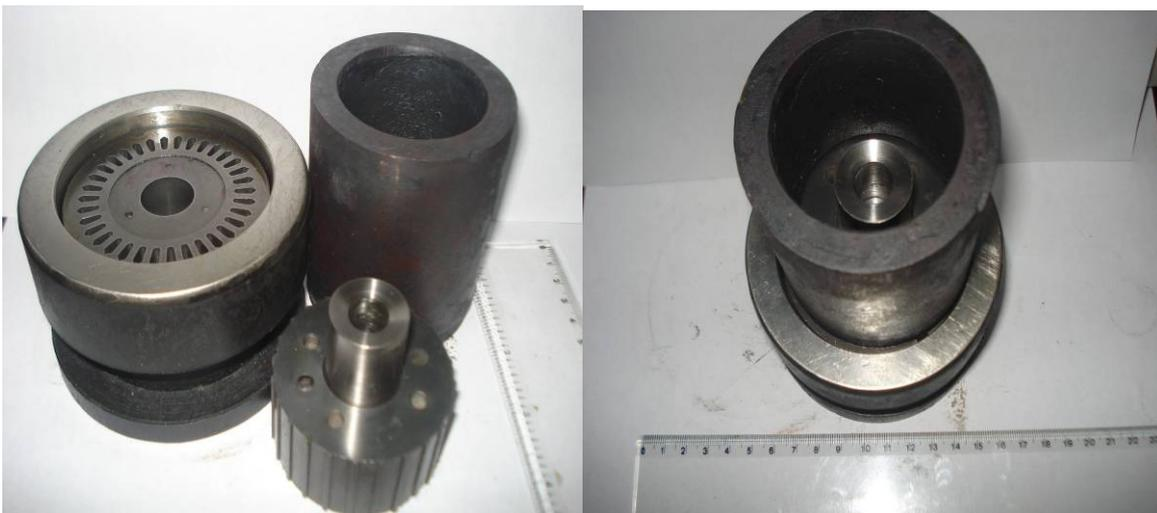
Figura 49: Dispositivo final do “Copo-quente”.
