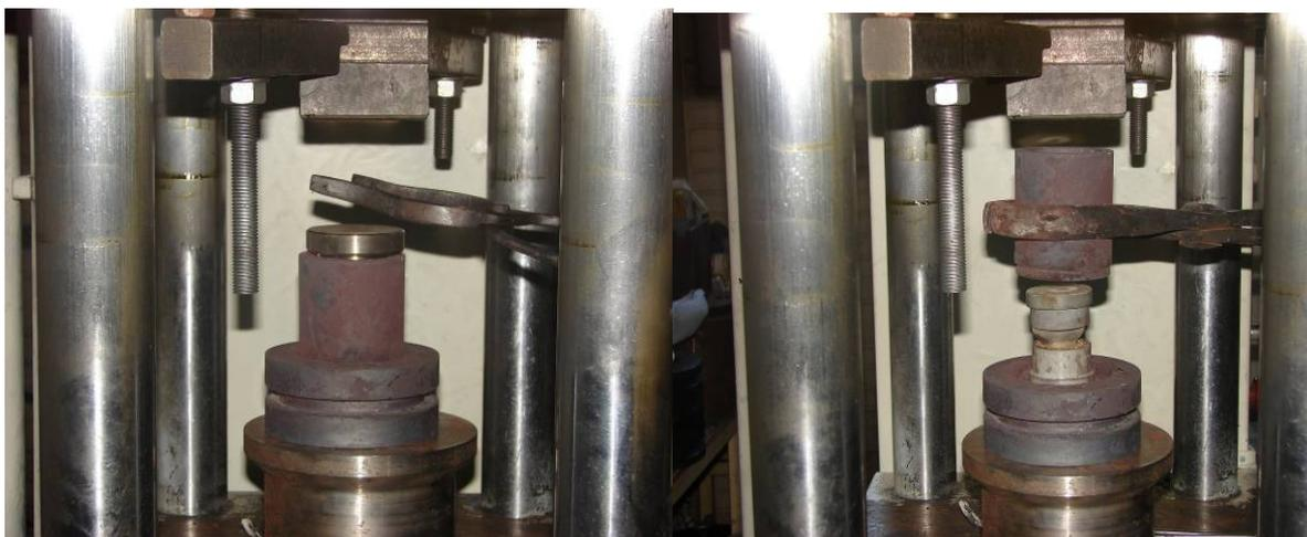
Figura 52: (Esq.) Dispositivo instalado na prensa e (Dir.) realização do ensaio.
