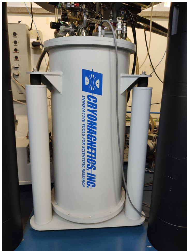
Figure 1 – C-Mag Vari-9 Cryogen-Free Cryostat - Cryomagnetics, Inc. - in the Laboratório de Resistividade, Magnetismo e Supercondutividade (LabRMS).
