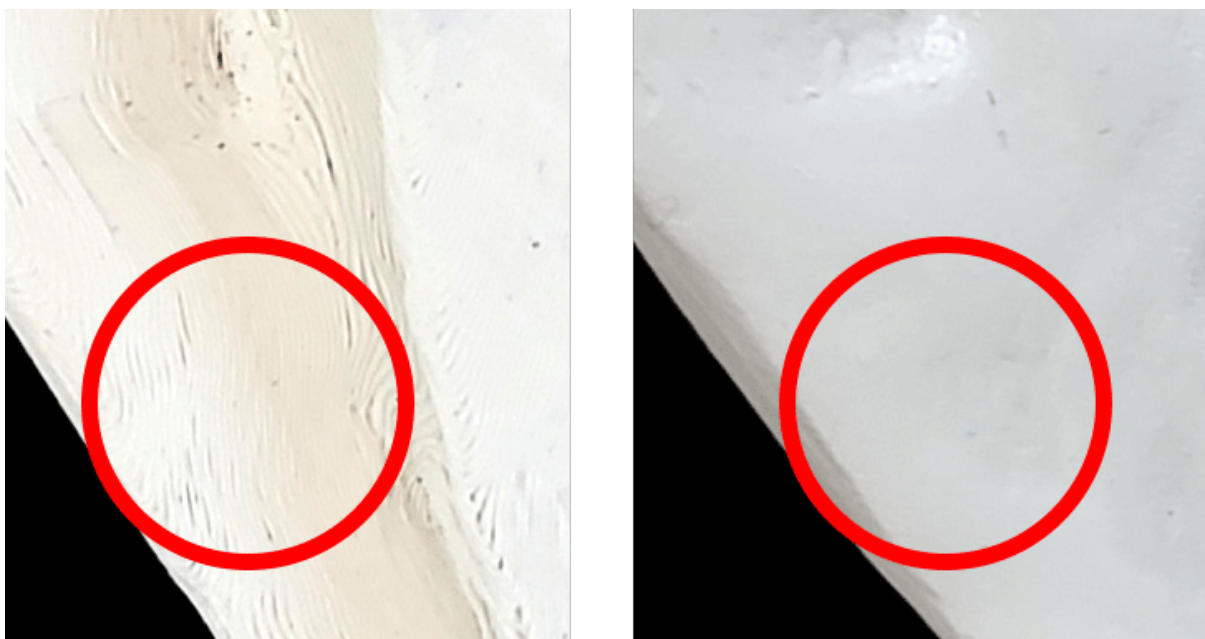
Figura 143 – Detalhe da textura produzida pela impressão por extrusão de material (à esquerda) e sua suavização com acabamento superficial (à direita)
