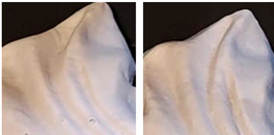
Figura 142 – Detalhe das réplicas do ornato do Museu do Doce: à direita, peça obtida por luz estruturada, à esquerda, peça obtida por fotogrametria
