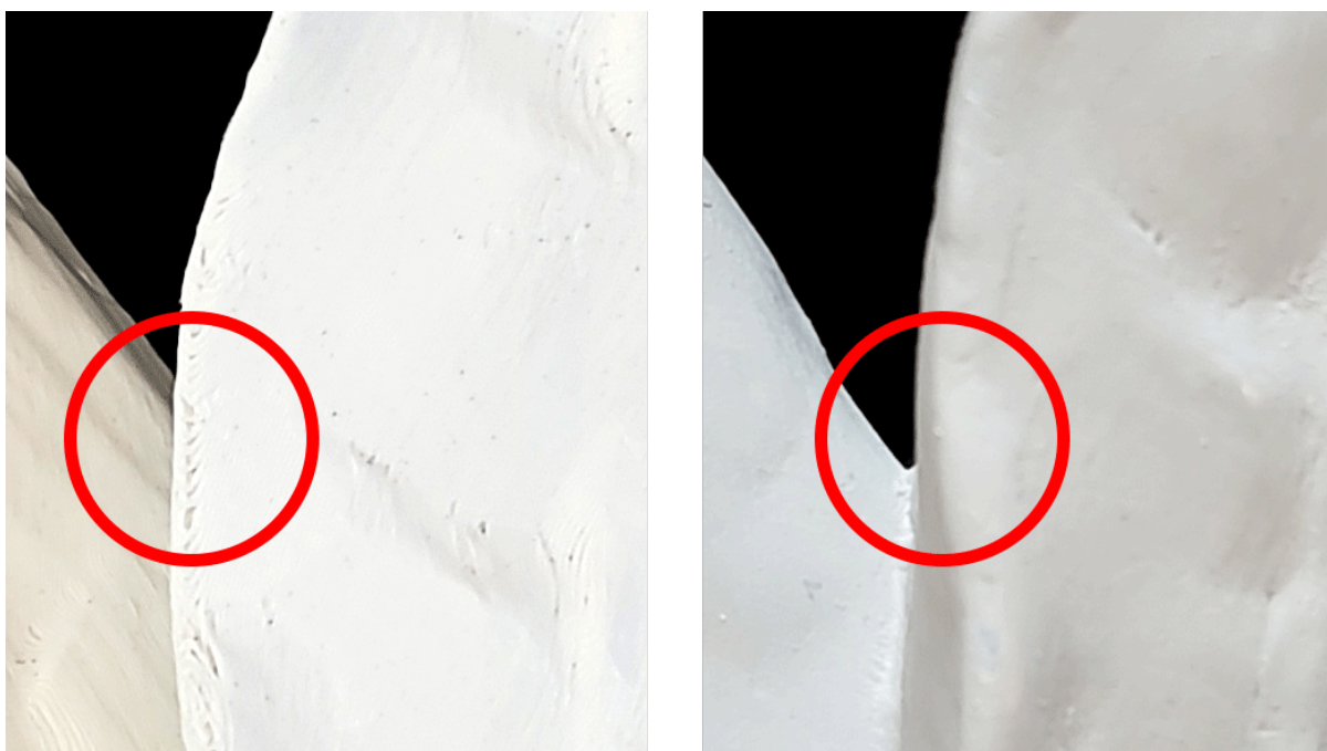
Figura 144 – Detalhe dos “degraus” produzidos pela impressão por extrusão de material (à esquerda) e sua suavização com acabamento superficial (à direita)
