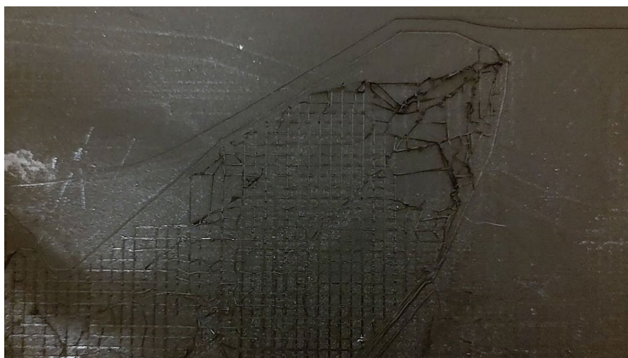
Figura 109 – Impressão irregular em TPU
