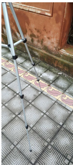
Figura 33 – Ladrilhos usados como referência para manutenção da distância entre o ornato e a câmera
