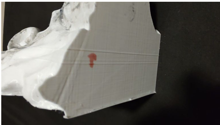
Figura 127 – Efeito “pata de elefante” causado por falta de energia durante a impressão (marcação em vermelho)
