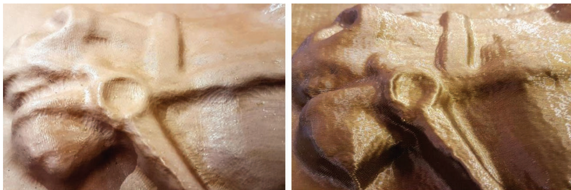
Figura 24 – Detalhes das peças fabricadas por usinagem CNC (à esquerda) e por impressão por extrusão de material (à direita)
