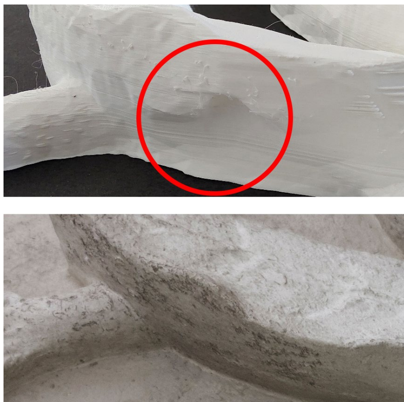
Figura 119 – Depressão no modelo impresso (à esquerda), não presente no ornato (à direita)
