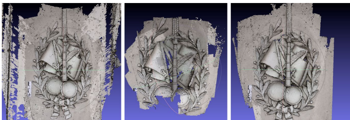
Figura 81 – Nuvens de pontos do ornato do MALG criadas a partir de 98 (à esq.), 95 (centro) e 33 imagens (à dir.)
