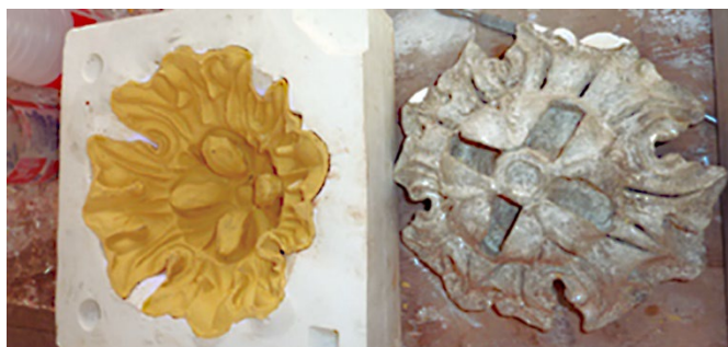
Figura 3 – Molde de silicone em cama de gesso e ornato nele produzido
