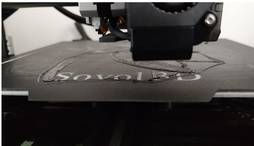
Figura 113 – Cabeçote extrusor parado, sem as camadas de impressão esperadas entre ele e as últimas camadas impressas
