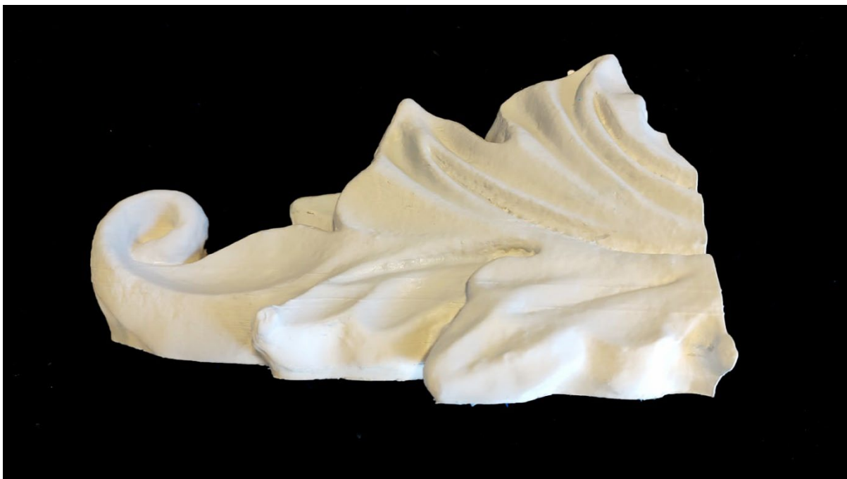
Figura 133 – Impressão do ornato do Museu do Doce com acabamento superficial finalizado, pronta para moldagem
