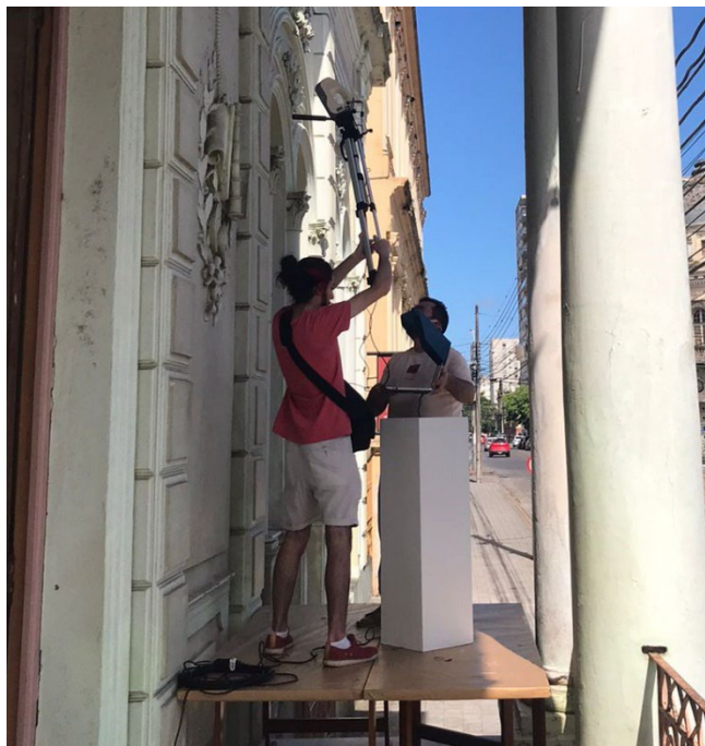
Figura 30 – Digitalização por luz estruturada do ornato do MALG
