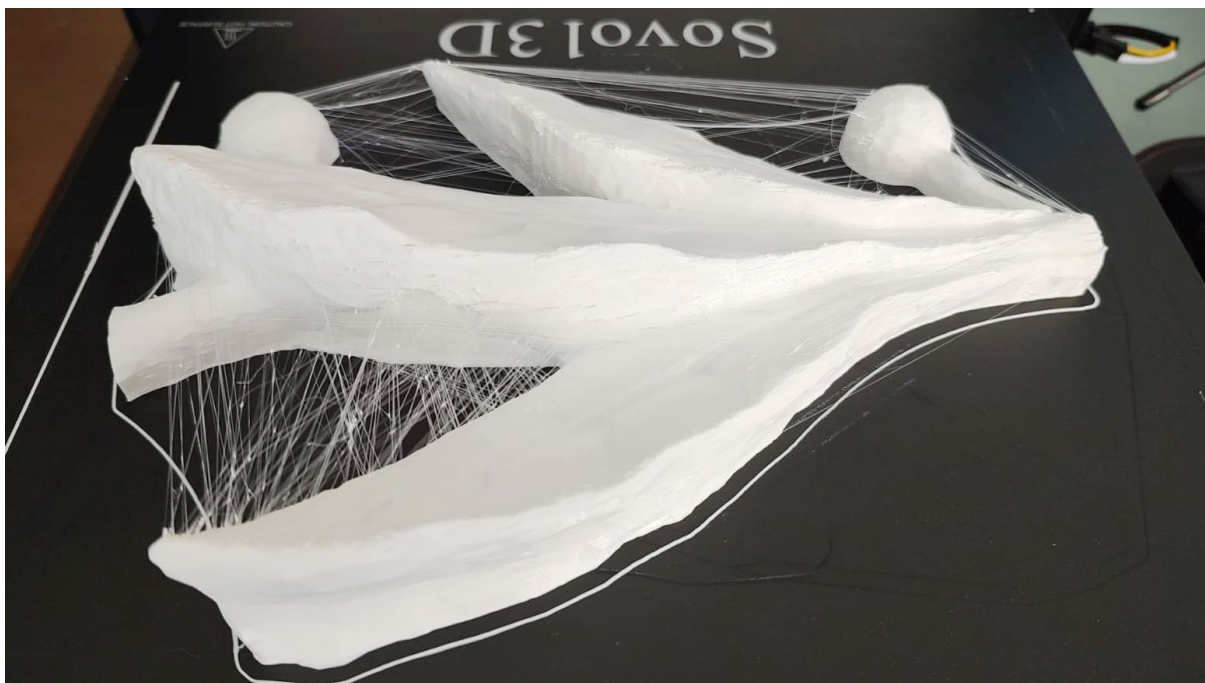
Figura 115 – Impressão de detalhe do ornato do MALG apresentando strings
