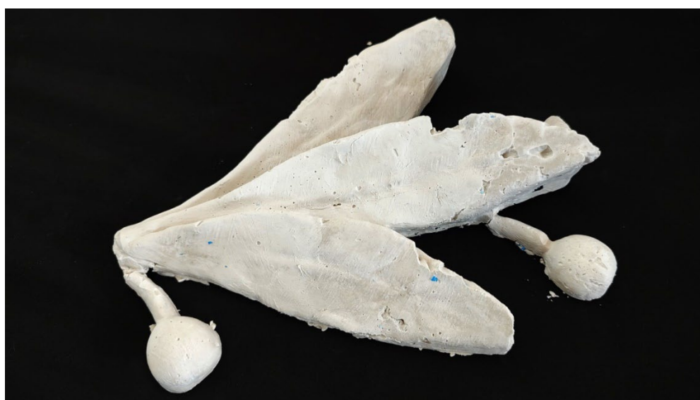
Figura 137 – Réplica do ornato do MALG com falhas devido ao endurecimento prematuro do gesso
