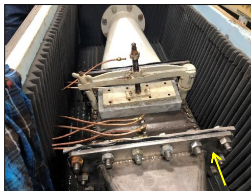
Figura 4-5: Representação gráfica do dispositivo tipo Venturi e das peças que auxiliam na conexão com o sistema hidráulico (a); máquina de cavitação utilizada nos ensaios do USBR (b), a seta indica o sentido do fluxo.
