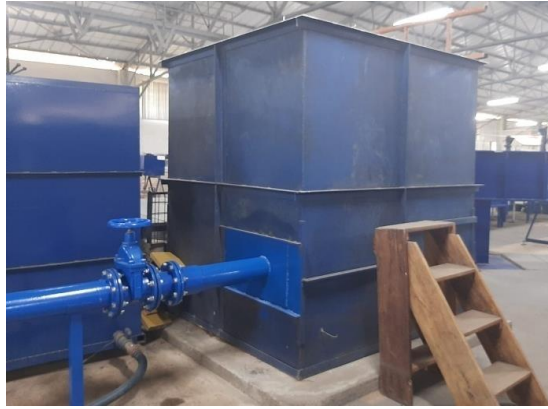
Figura 4-16: Reservatório superior readequado ao sistema para auxiliar na dissipação de energia do escoamento após a saída do circuito hidráulico.
