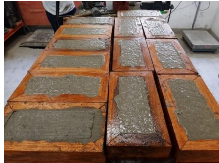
b) Blocos de concreto moldados.
