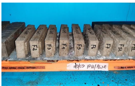
Figura 4-38: Armazenamento dos blocos e CPs em câmara úmida.
