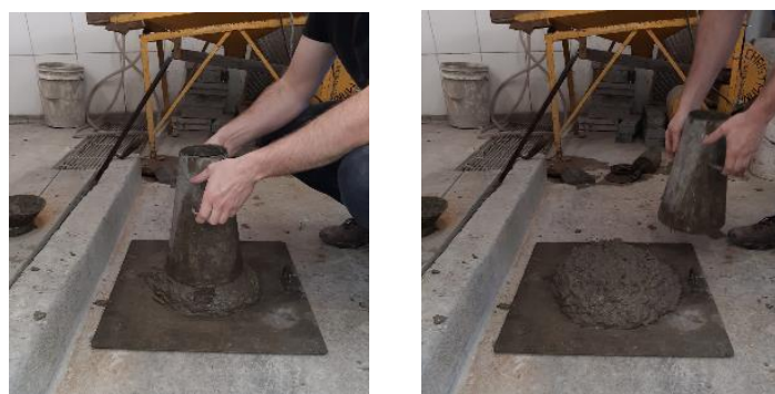
Figura 4-36: Realização do Slump Test .
