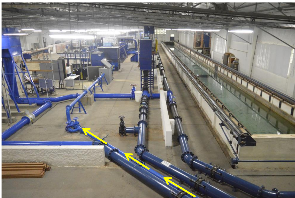
Figura 4-15: Instalação experimental do Laboratório de Obras Hidráulicas, as setas em amarelo indicam o sentido do escoamento.
