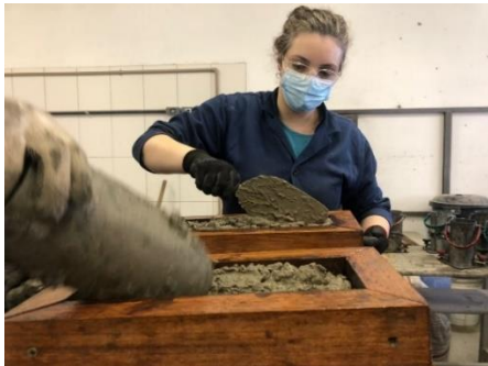
a) Inserção de concreto nas formas.
