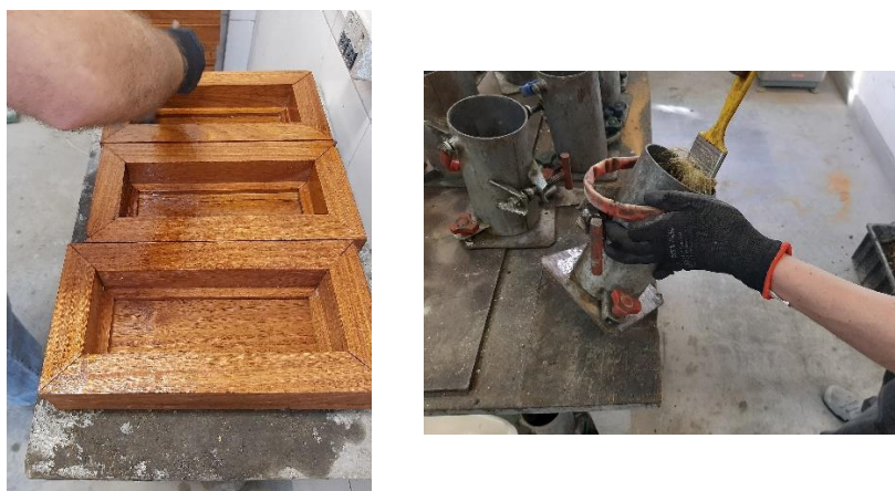
Figura 4-34: Limpeza e adição de desmoldante nas formas.
