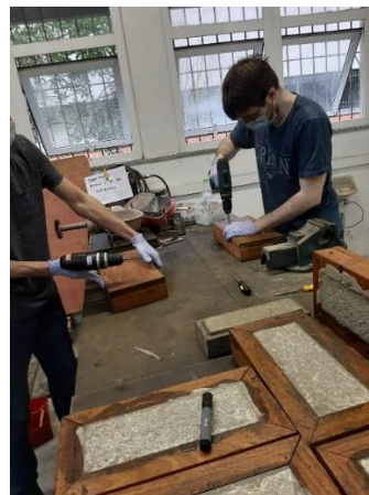
d) Desforma dos blocos de concreto.
