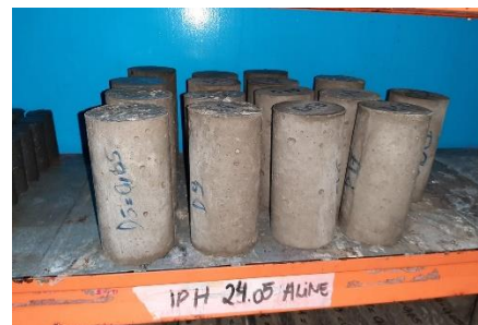
Figura 4-38: Armazenamento dos blocos e CPs em câmara úmida.
