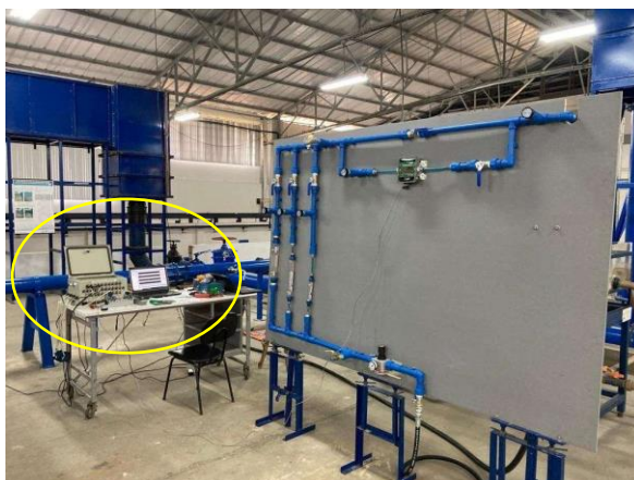
Figura 4-24: Sistema de aquisição de dados ao lado do painel de instrumentação de ar.
