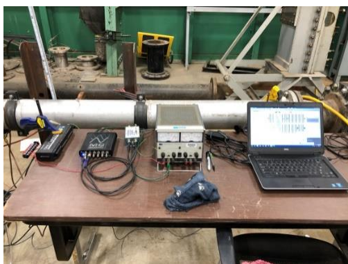
Figura 4-11: Sistema de aquisição de dados de pressão.
