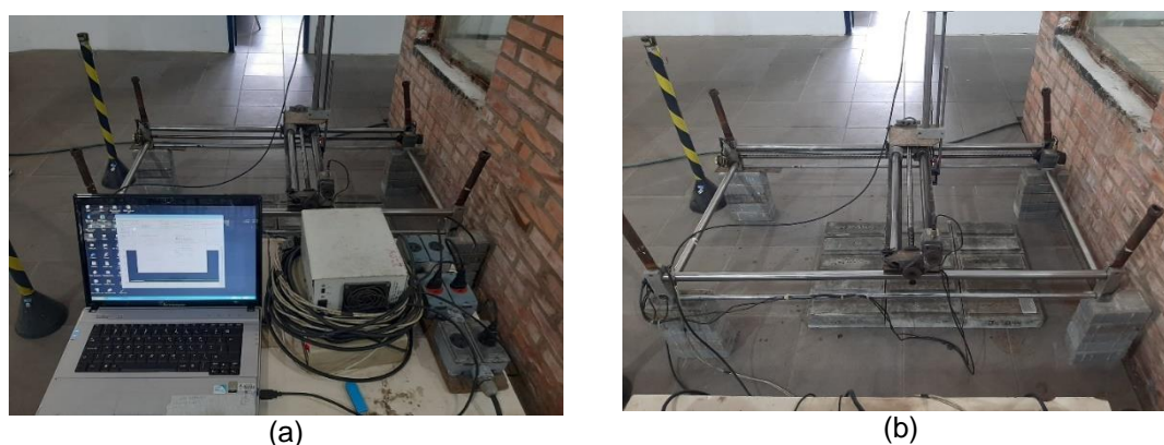
Figura 4-41: Sistema de aquisição dos pontos “x”, “y” e “z” (a), e Mesa de Coordenadas Automatizada com o Perfilador a Laser (b).
