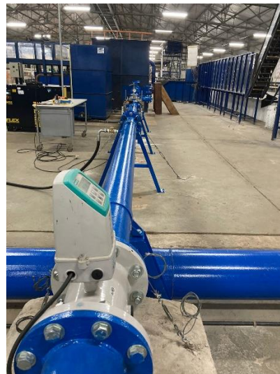
Figura 4-20: Medidor e transmissor eletromagnético de vazão de água.
