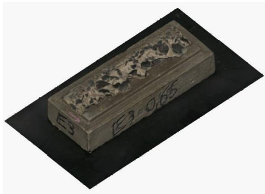
(c) Superfície 3D formada pela sobreposição de imagens e curvas de nível em extensão .dwg utilizadas na estimativa dos volumes erodidos.
