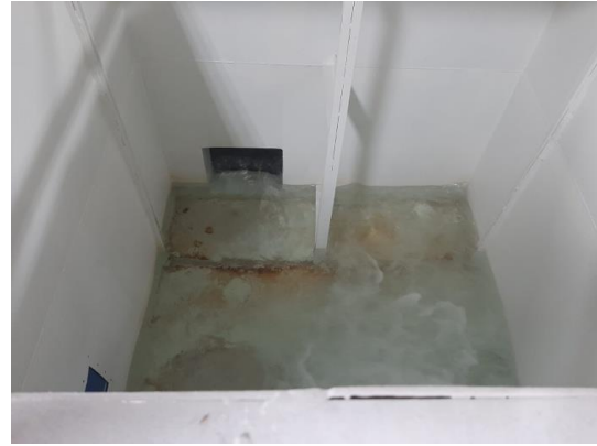
Figura 4-16: Reservatório superior readequado ao sistema para auxiliar na dissipação de energia do escoamento após a saída do circuito hidráulico.
