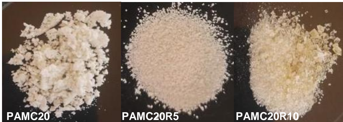
Figura 11 - Hidrogel à base de poli(acrilamida) a partir da polimerização em emulsão inversa com 20% de monômero catiônico e 0%, 5% e 10% de reticulante respectivamente.
