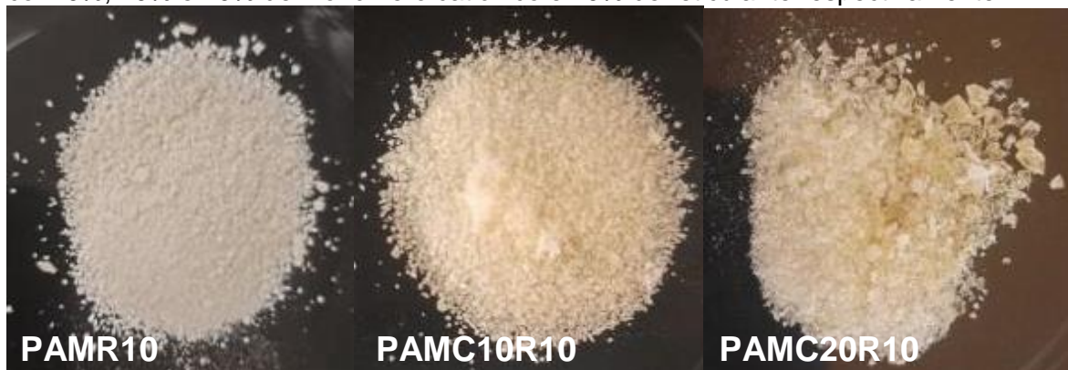
Figura 13 - Hidrogel à base de poli(acrilamida) a partir da polimerização em emulsão inversa com 0%, 10% e 20% de monômero catiônico e 10% de reticulante respectivamente.
