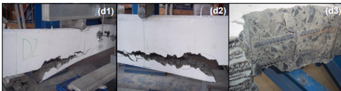
Figura 42 – Ruptura experimental de uma viga do grupo D
