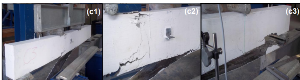
Figura 41 – Ruptura experimental de uma viga do grupo C
