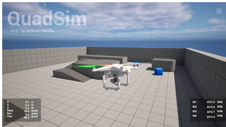
Figura 26: Visualização gráfica da simulação do quadricóptero no ambiente Unreal Engine.
