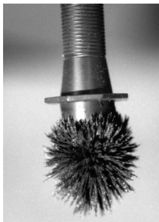
Figura 2 - Pincel magnético carregado com pó magnético. 15
