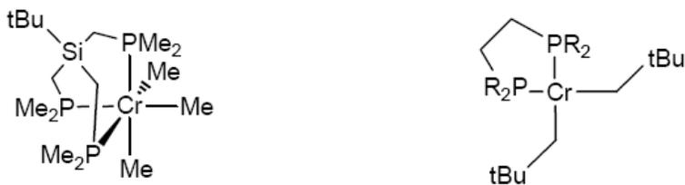
**Figura 12:** Catalisadores Amoco para a obtenção de 1-hexeno [25].
