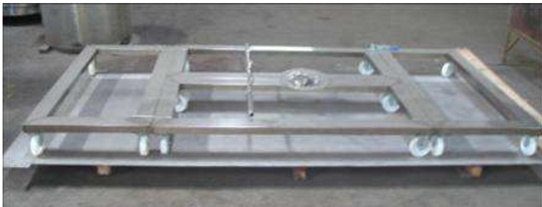
Módulos dispostos na configuração da planta. Detalhe para as rodas que permitem a locomoção do sistema quando os módulos forem desconectados através das alavancas.
