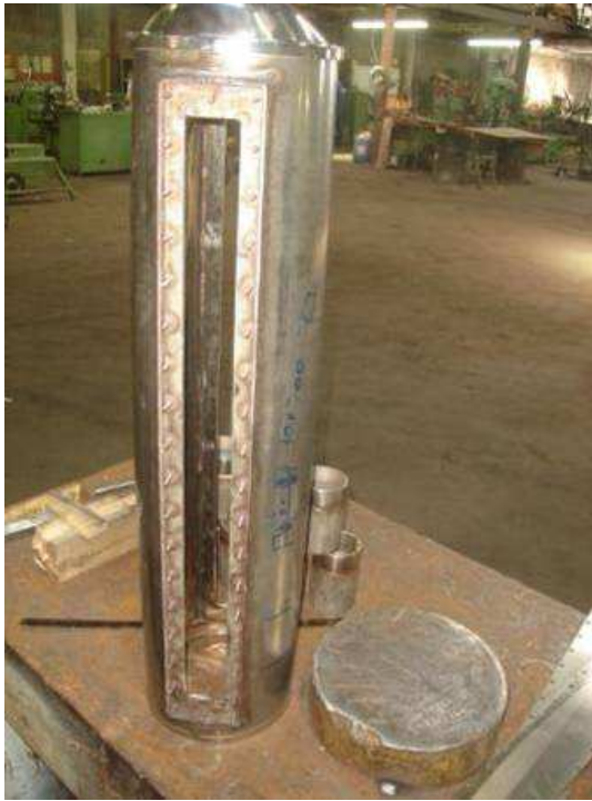
Decantador com visor de nível em toda sua extensão e evaporador circundado por cintas metélicas que promovem seu aquecimento para remoção do álcool residual.
