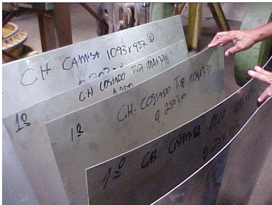
Chapas correspondentes às paredes dos tanques e reatores.
