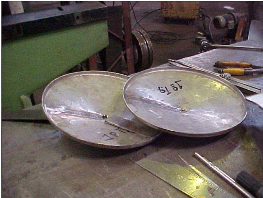
Fundo e tampa de um dos tanques.
