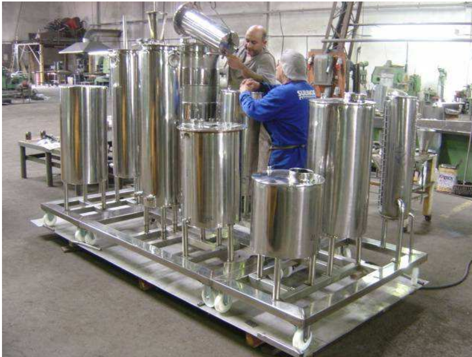
Equipamentos soldados em suas posições nos módulos.
