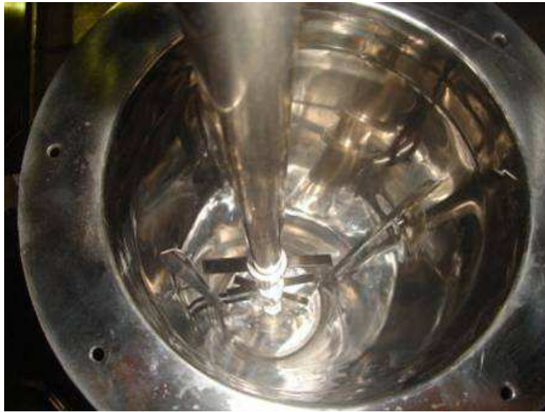
Parte interna de um reator, com agitador e quebra-ondas colocados.
