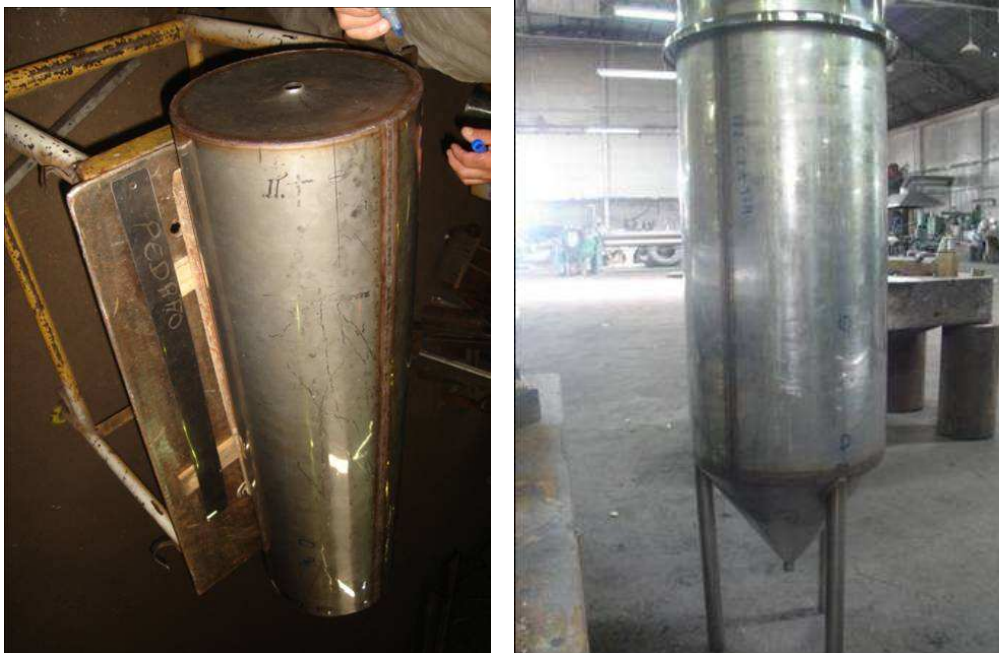
Tanques calandrados com os respectivos fundos e sustentações soldados.
