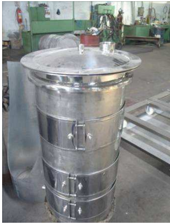
Decantador com visor de nível em toda sua extensão e evaporador circundado por cintas metélicas que promovem seu aquecimento para remoção do álcool residual.
