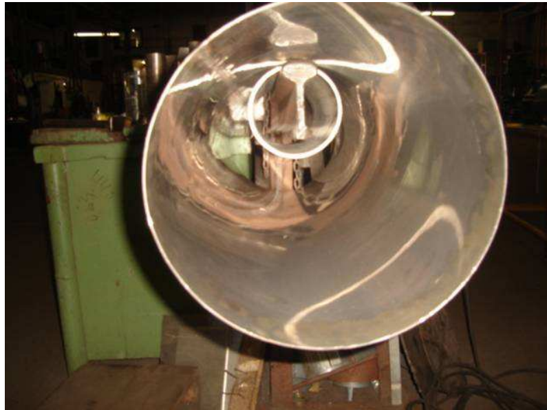
Chapa calandrada, formando a lateral de um tanque.
