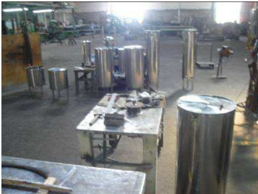
Tanques polidos e com os pedestais soldados para fixação nos respectivos módulos.
