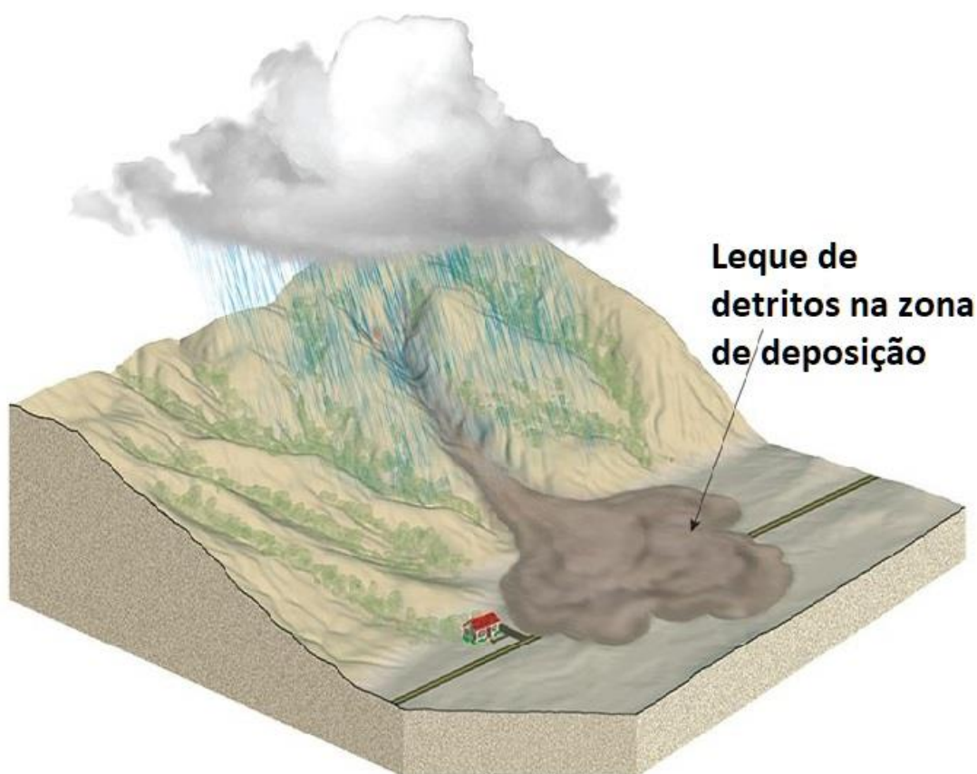
Figura 7: Representação de uma área de deposição de um fluxo de detritos em formato de leque.
