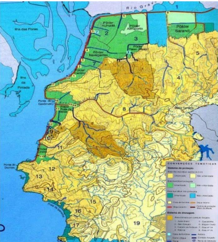
Sistema integrado de proteção contra inundações de Porto Alegre, com as estações de bombeamento de águas pluviais marcadas com números
