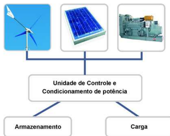
Figura 1 – Configuração de um sistema híbrido solar-eólico-diesel (Fonte: CRESESB)
