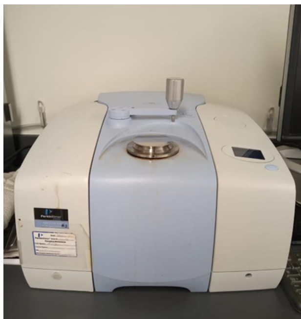
Figura 20 – Visão geral do espectrômetro FTIR PerkinElmer precisely Spectrum 100 utilizado para as análises de FTIR desta Tese.
