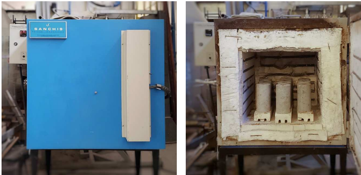
Figura 16 – Forno elétrico empregado para o aquecimento das amostras
