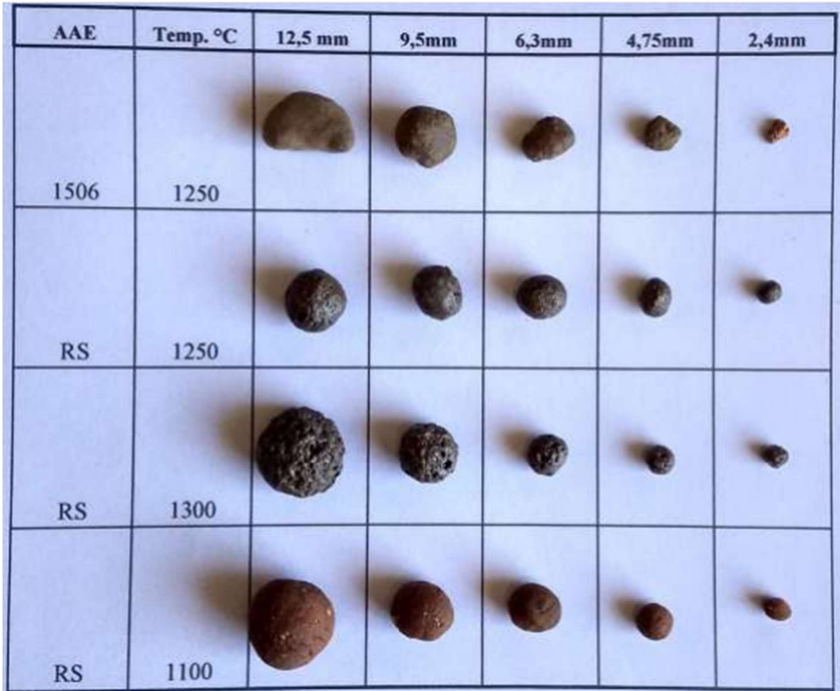
Figura 10: Quadro demonstrativo dos AAEs. Fonte: Rodrigues (2018).
