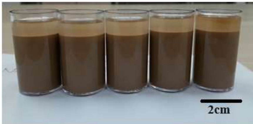
Figura 25: Pasta 1:0,7 com excesso de ativador após 2 horas.
