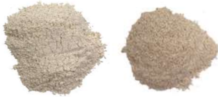
Figura 19: Argila de Pantano antes e depois de calcinada a 750 °C. Após calcinação, assumiu a coloração rosa.
