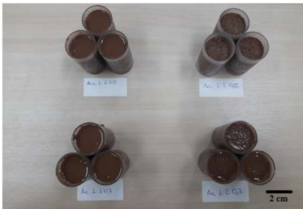
Figura 44: Moldagem de AG e observação após 3 horas antes de ser inserida na estufa a 50 °C.
