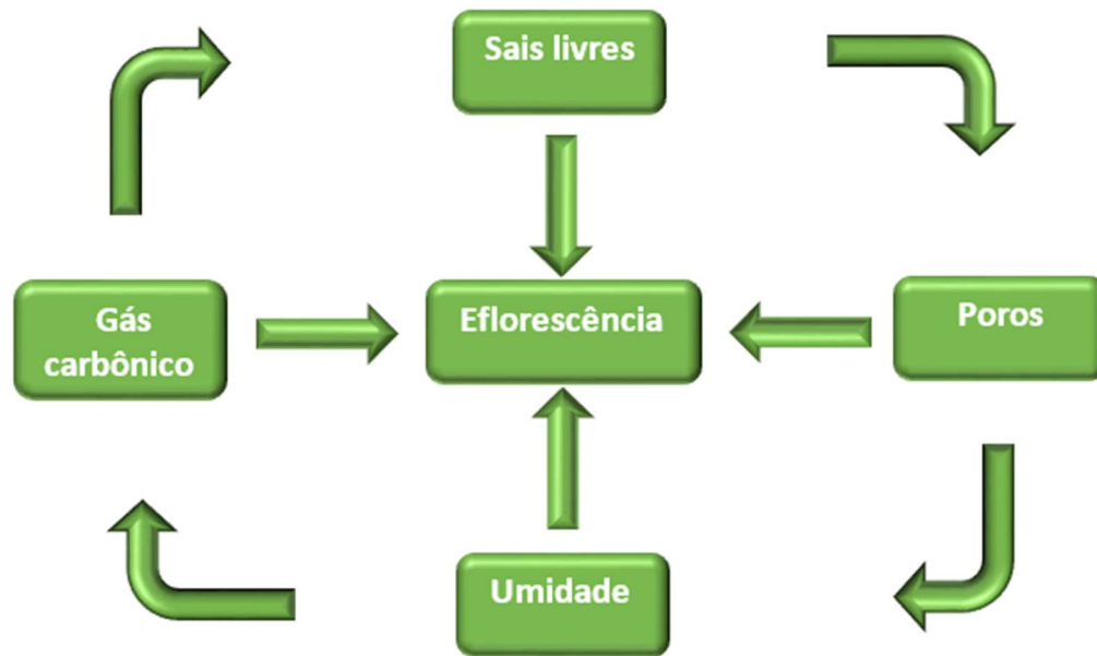
Figura 12: Ciclo dos principais fatores de formação de eflorescência. Fonte: O autor.
