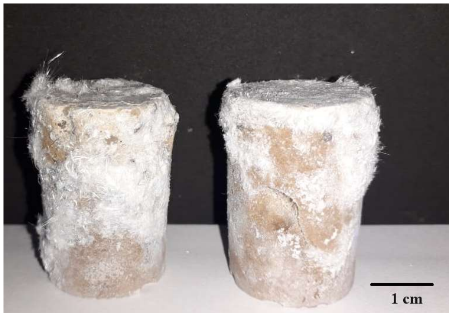
Figura 33: Amostra da PST III em concentração de 10 mol de NaOH ( \text{NaOH}:\text{Na}_2\text{SiO}_3 ) após 60 dias. Fonte: O autor
