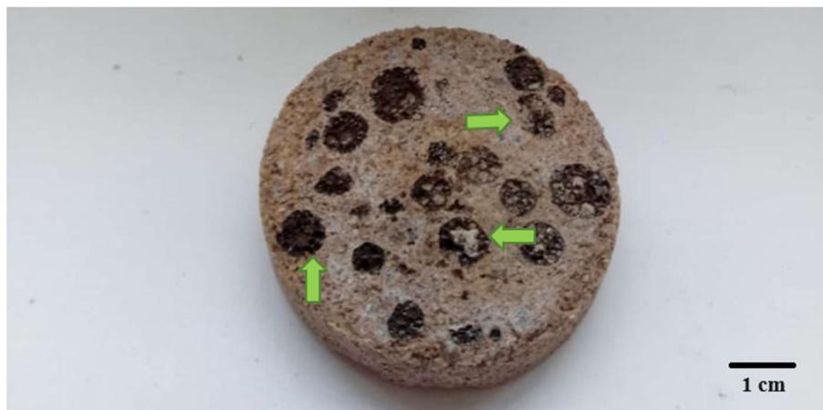
Figura 66: CGL com 30% de AAE-RS-1300 e AG III (1:2:0,5). Em destaque, a presença de argamassa no interior do agregado e boa aderência entre agregado e argamassa.
