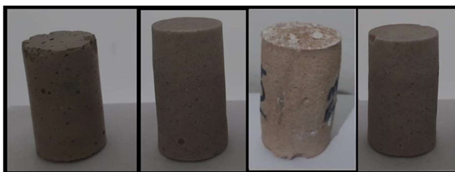
Figura 51: PST III 1:0,7 após aquecimento em 300 °C, 500 °C, 700 °C e 900 °C (da esquerda para a direita).
