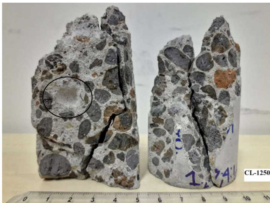
Figura 64: Micrografia óptica da superfície de fratura do concreto leve com cimento Portland e AAE-1250 (CL-1250) mostrando a interação entre o AAE-1250 e a argamassa. Em destaque, o deslocamento de apenas um agregado diante de uma grande área e a fissura através dos agregados.
