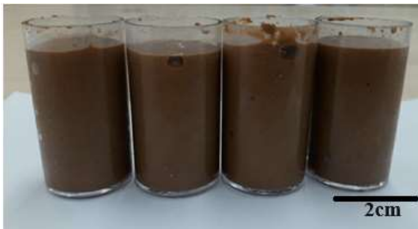
Figura 26: Pasta 1:0,5 com quantidade “ideal” de ativador após 2 horas.
