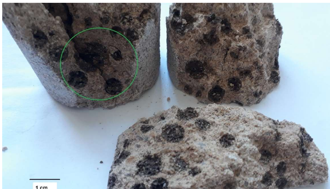
Figura 67: CGL com 30% de AAE-RS-1300 e AG III (1:2:0,5). Superfície de fratura. Em destaque, a trinca através do agregado.
