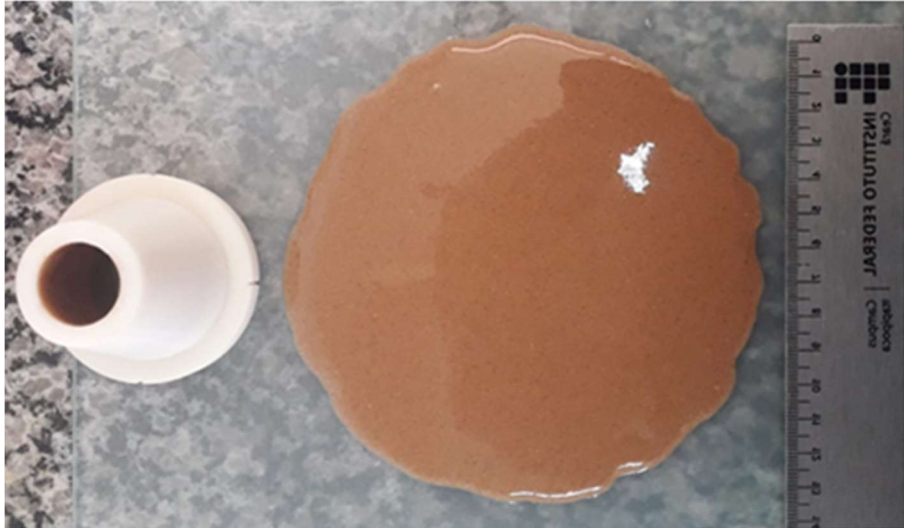
Figura 28: Ensaio de mini- slump na PST 1:0,5 com 10 mol e seu espalhamento.
