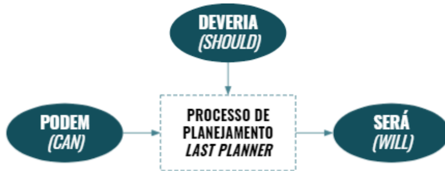
Figura 2 - Formação do processo de planejamento Last Planner
