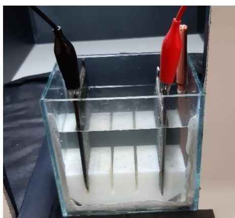
(a) Módulo para experimento de geração de hidrogênio
