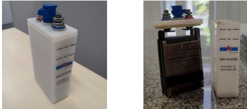
Figura 20: Bateria Ni-Fe e eletrólito KOH utilizados no estudo com e sem invólucro
