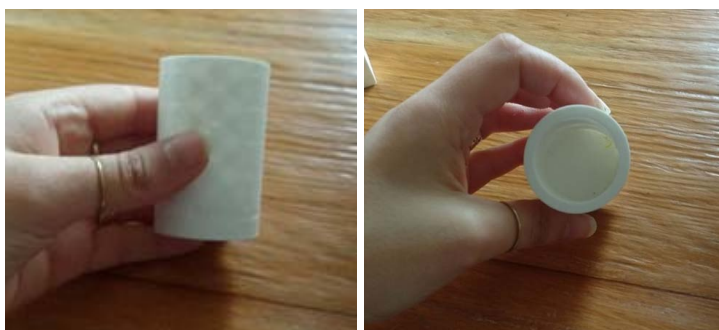
Figura 4: modelo 3D da SisperDesign replicando traqueia infantil. Registrado pela autora no escritório da SisperDesign.
